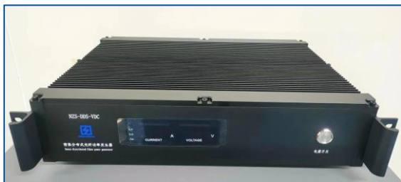
电流: \leq 10A 电压: 0\sim 300V
